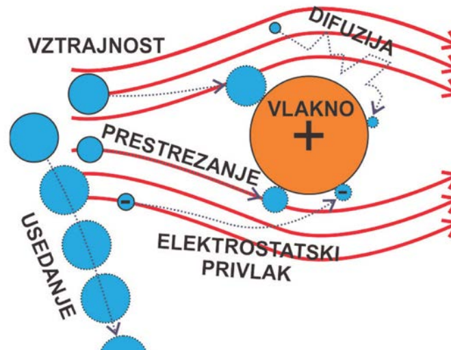
Slika 5: Shematski prikaz različnih mehanizmov filtracije
