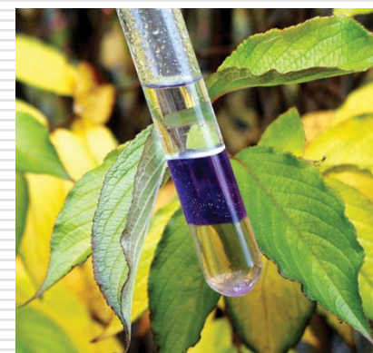
Mikroreaktor s strnjenim slojem imobiliziranega encima za izvedbo biotransformacij v različnih topilih
