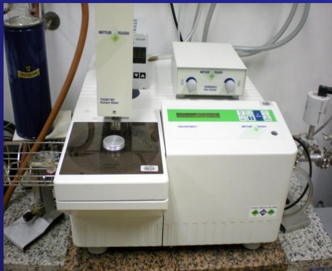
Termoanalizator Mettler Toledo TGA/SDTA 851 e in avtomatski vzorčevalnik.
