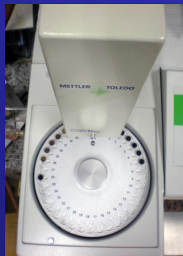
Termoanalizator Mettler Toledo TGA/SDTA 851 e in avtomatski vzorčevalnik.
