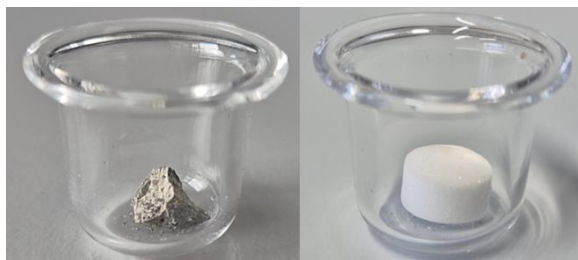
Slika 9: Vzorec v vžigalnem lončku.
