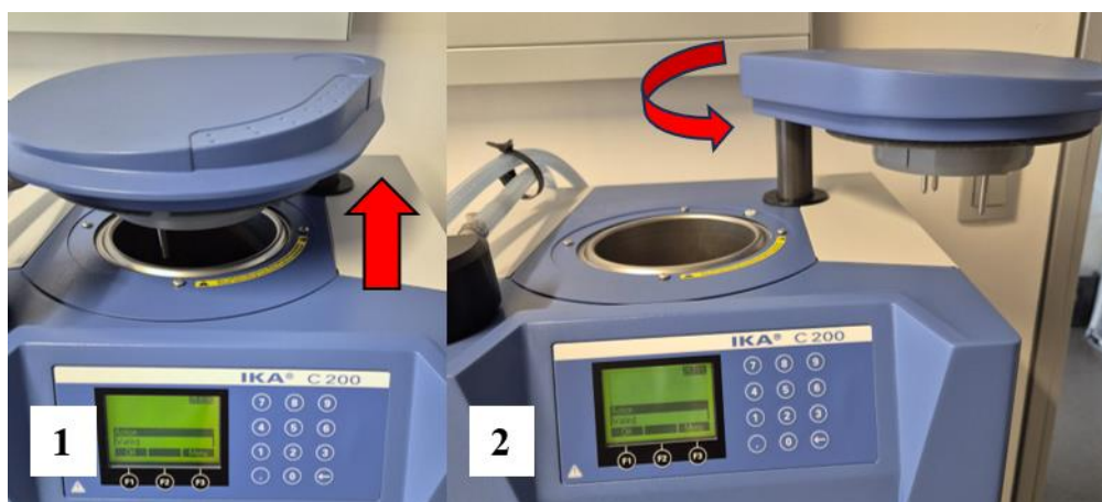
Slika 15: Odpiranje pokrova kalorimetra.
