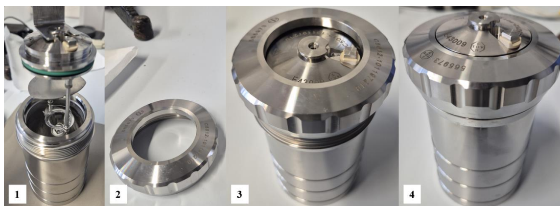
Slika 12: Vstavljanje vzorca in zatesnitev posode kalorimetra.
