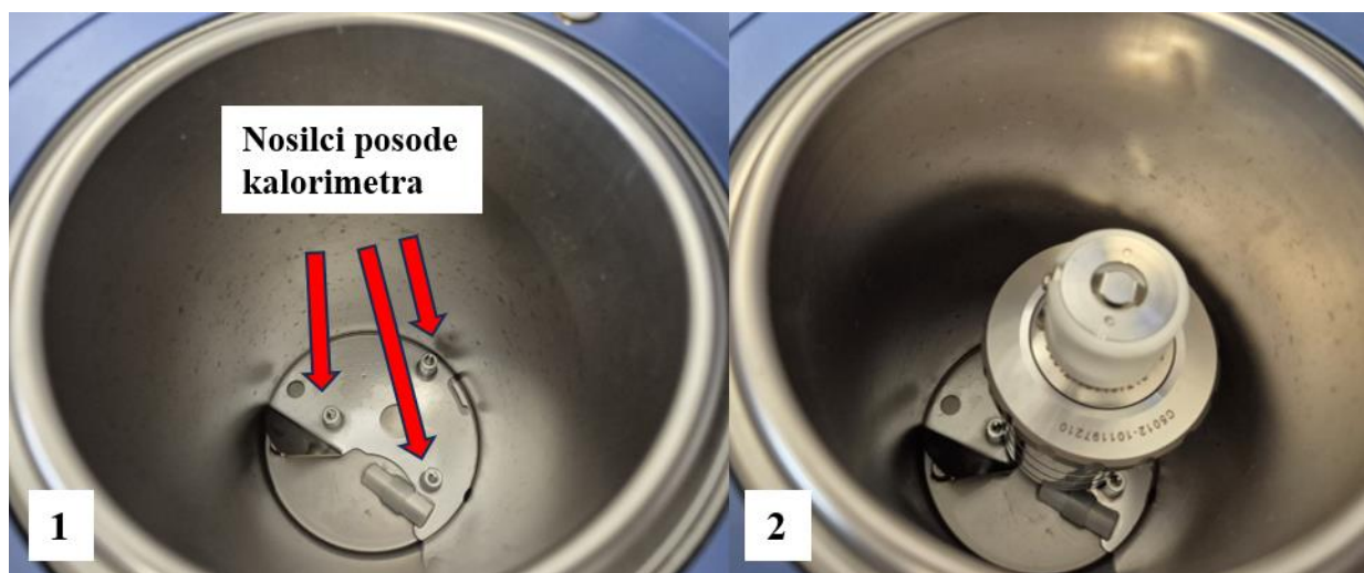
Slika 16: Postavitev posode v kalorimeter.
