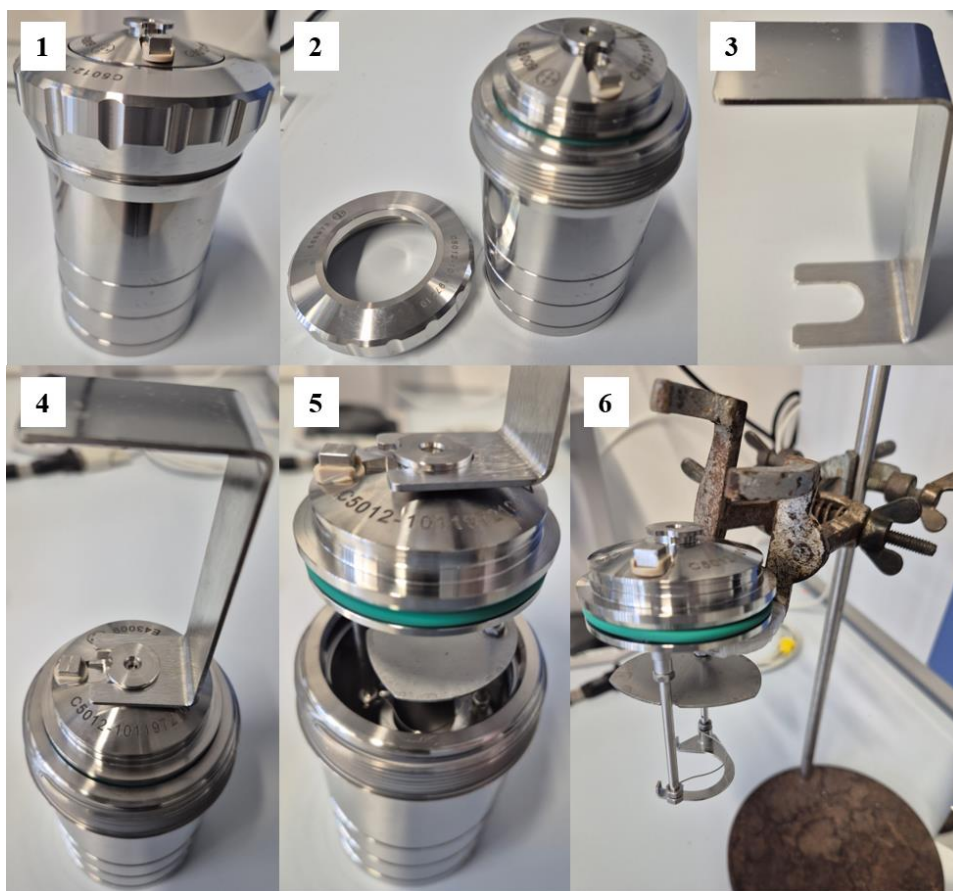
Slika 10: Odpiranje posode kalorimetra in odstranitev srednjega dela posode.
