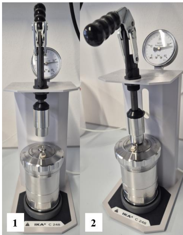
Slika 13: Polnjenje posode kalorimetra na polnilni posodi.
