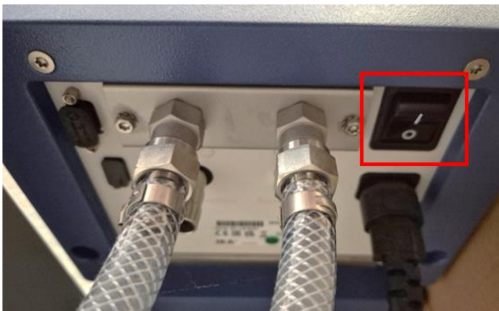
Slika 1: Stikalo za vklop/izklop vodne črpalke.
