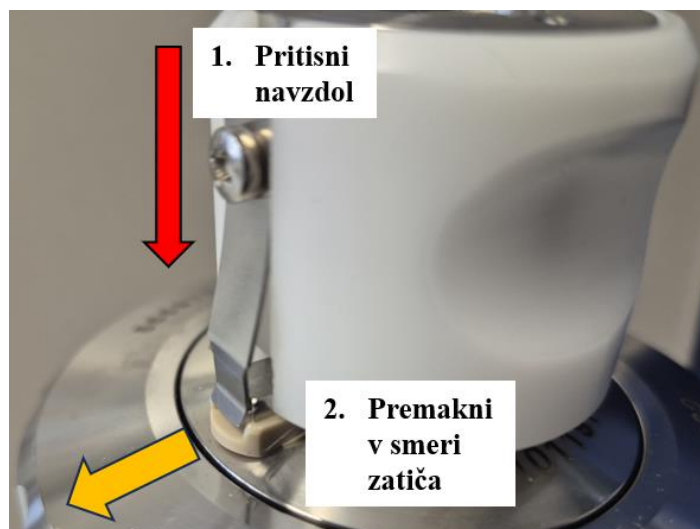
Slika 27. Odstranitev nastavka na zgornjem delu posode kalorimetra.
