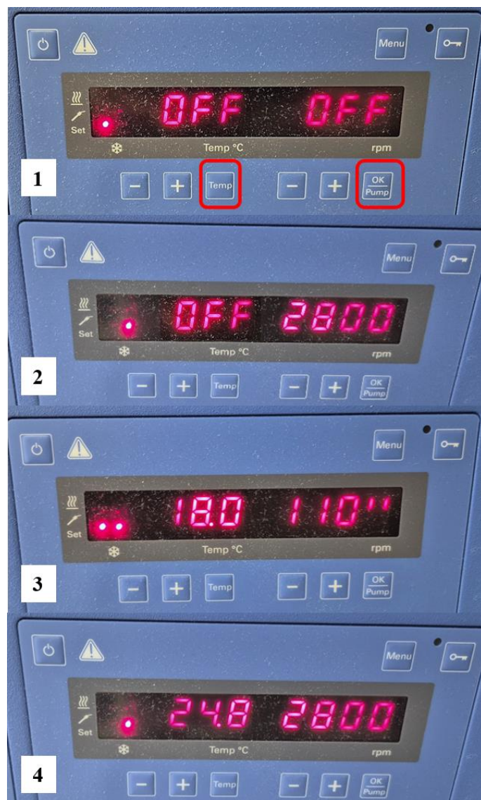
Slika 2: Vkllop črpanja vode in vkllop ohlajanja/segrevanja vode.
