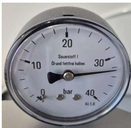
Slika 7: Stanje merilnika po odprtju ventila za dotoka kisika do polnilne postaje.
